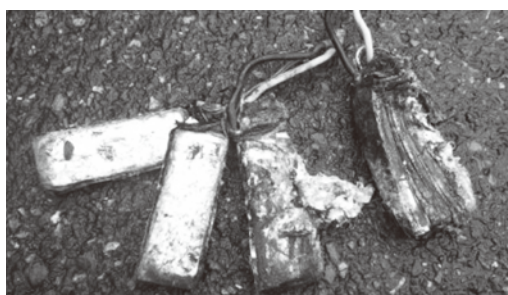
実際にリサイクル施設で発火したリチウムイオン電池
