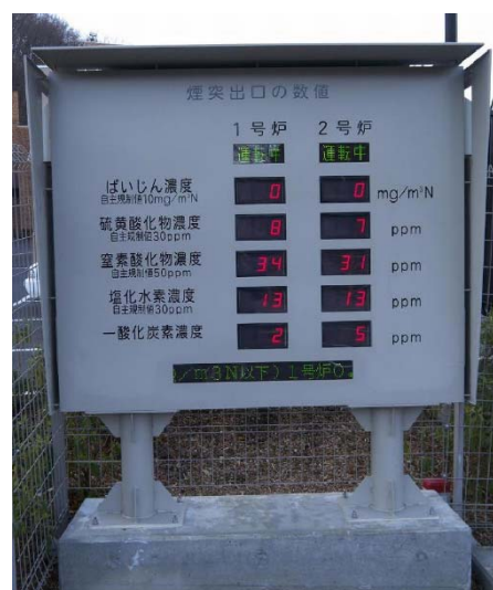
図 2-9-1 モニタリングポストの例 (はだのクリーンセンター排ガスデータ電光表示盤) 秦野市伊勢原市環境衛生組合ホームページ
